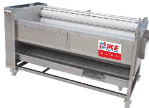
我們為不同的清洗需求提供多種不同的毛輥，包括軟毛刷、硬毛刷和金剛砂輥。如果您只需去除根莖蔬菜的雜質，軟毛刷是最佳選擇。而硬毛刷輥和金剛砂輥在根莖類蔬菜去皮方面表現卓越。
